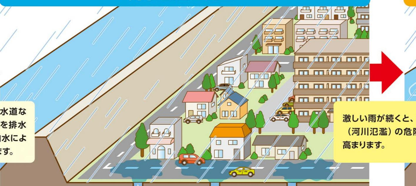
内水氾濫とは、雨の量が下水道などの排水能力を超えたときや、河川などの排水先の水位が高くなったりときに雨水を排水できなくなり、浸水することです。
