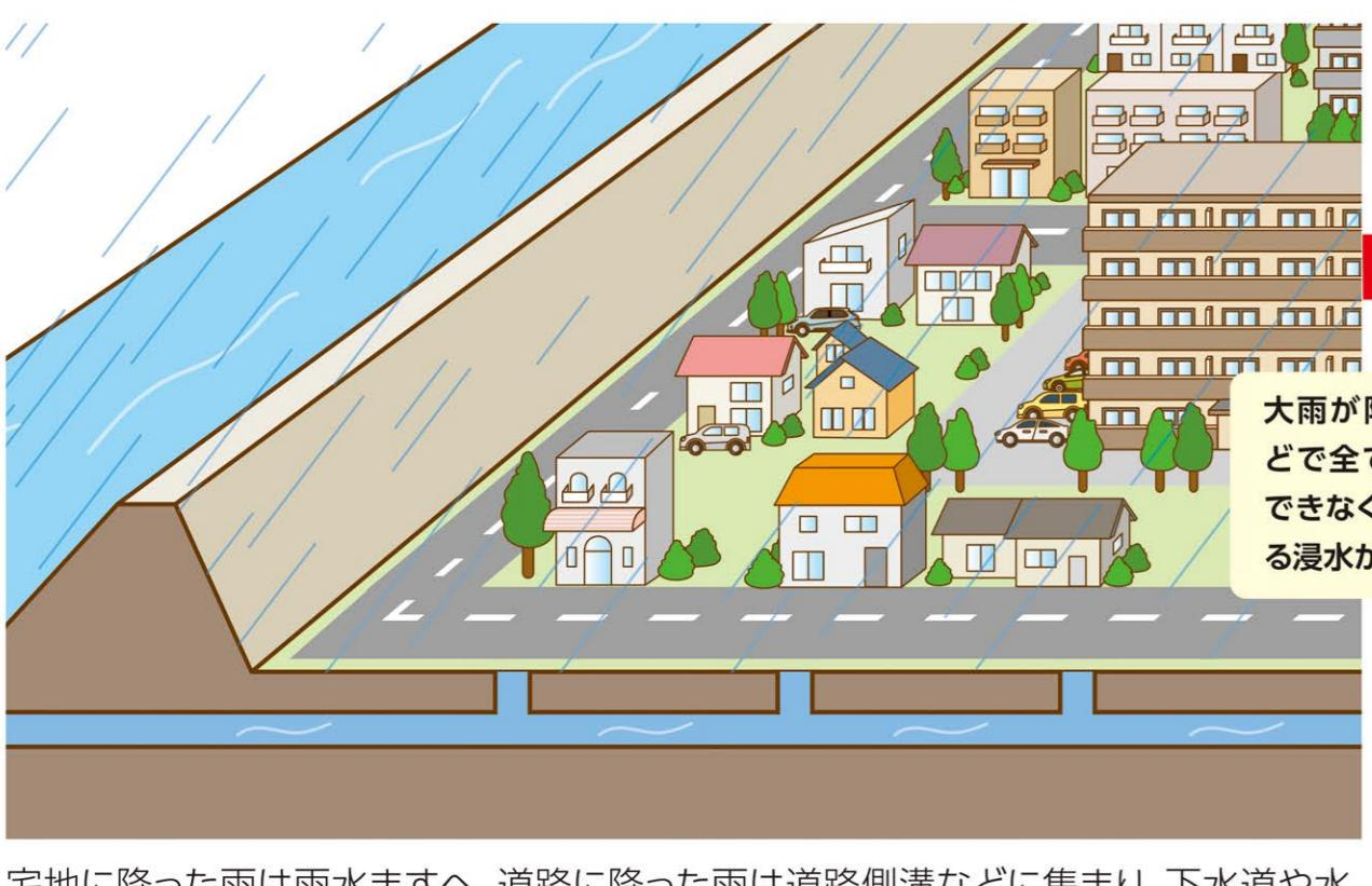
宅地に降った雨は雨水ますへ、道路に降った雨は道路側溝などに集まり、下水道や水路等を通って河川に排水されます。
