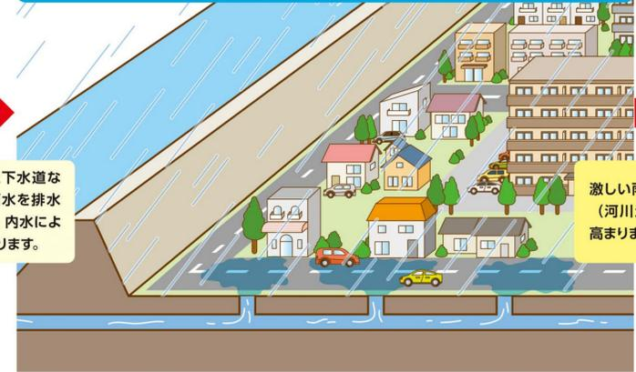
内水氾濫とは、雨の量が下水道などの排水能力を超えたときや、河川などの排水先の水位が高くなったときに雨水を排水できなくなり、浸水することです。
