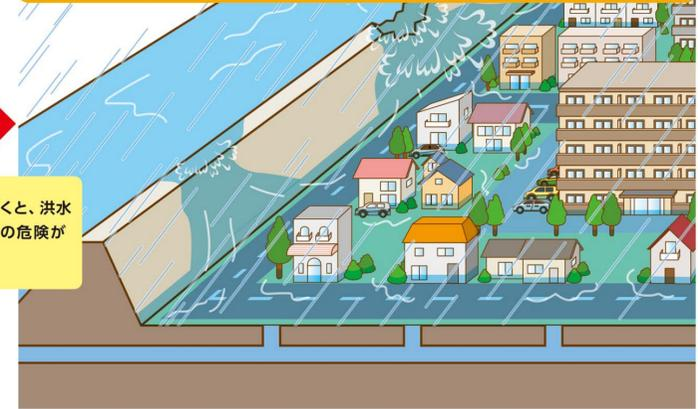
洪水(河川氾濫)とは、大雨によって河川などの水位が上昇し、堤防を越えて水があふれたり、堤防の土砂が流出して決壊したりすることです。家屋の倒壊や流出など、大規模な被害を引き起こします。
