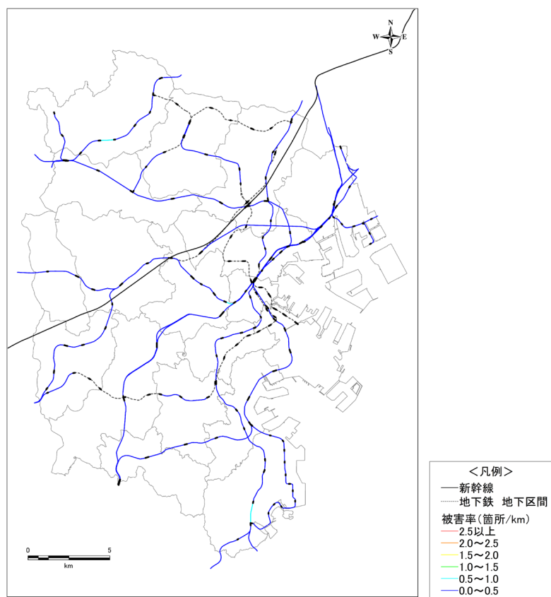
図 7-1 3 鉄道の揺れによる被害率（単位：箇所/km）：南海トラフ巨大地震
