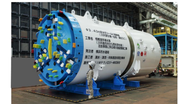
写真3 シールドマシン
