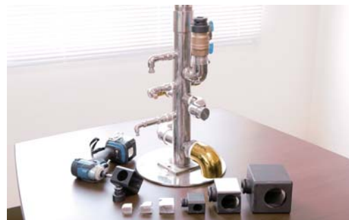
当社開発の継手着脱用ドライバーアタッチメントとトレーニング機具
