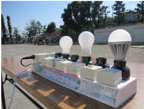
▲ソーラーパネルで発電し、白熱電球・電球型蛍光灯・LED電球の消費電力を確認
